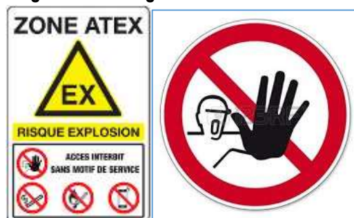
Figure 17 : Pictogrammes d'accès restreint
