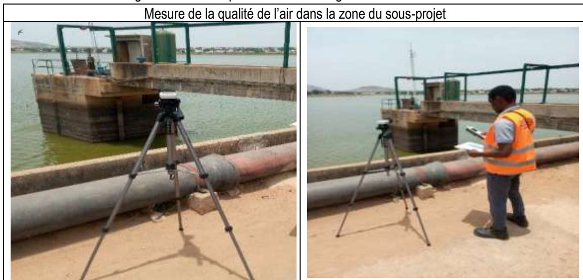
Planche 3: Images illustrant l'étape de mesures des gaz de combustion dans l'air ambiant
