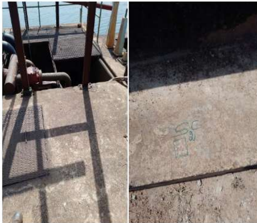
Photo 4 : Essais sur béton durci au scléromètre au niveau du déversoir
