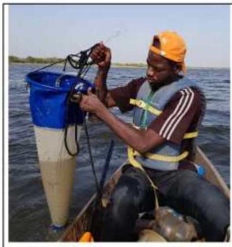
Figure 3 : Vue de la technique d'échantillonnage du plancton à l'aide du filet à plancton
