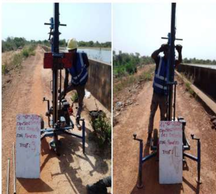
Photo 2 : Essais de pénétration dynamique au pénétromètre dynamique lourd
