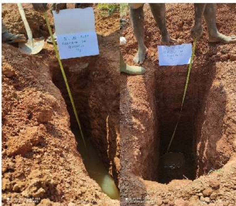
Photo 3 : Puits à ciel ouvert au pied de talus
