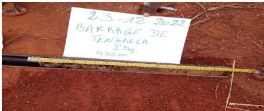
Photo 5 : Carotte dans le carottier échantillonneur
