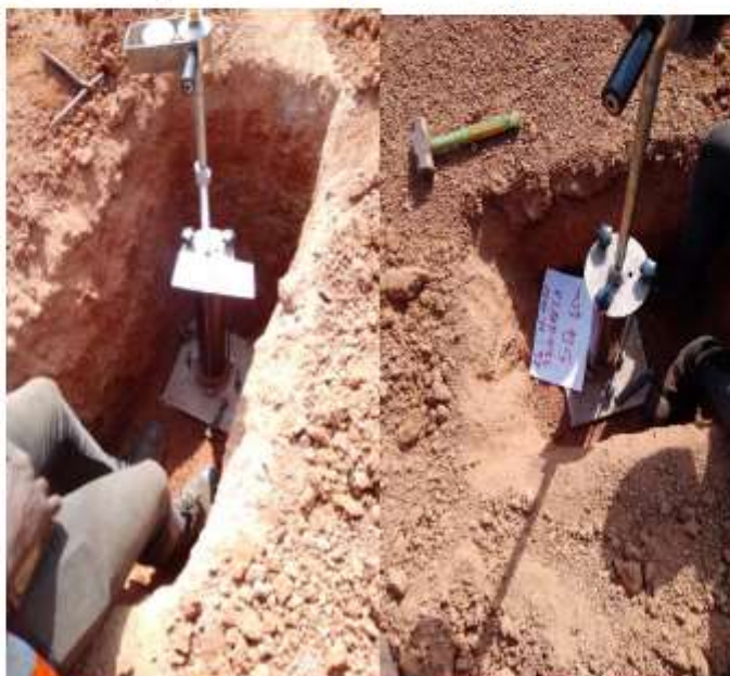
Photo 1 : Contrôle de compacité au densitomètre à membrane de 3 litres
