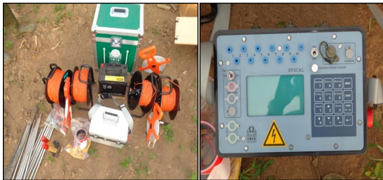
Figure 2: Equipement du résistivimètre syscal pro (Iris Instrument)
